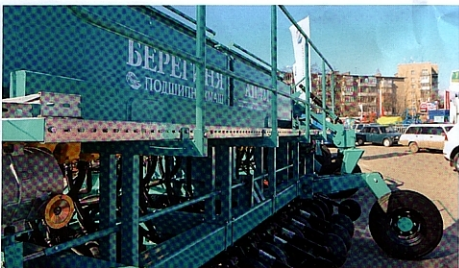
Селлка прямого посева «Берегиня» АП-421 имеет 26 монодисковых сошников с ребордами.
