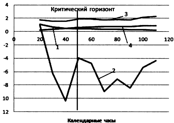
Рис. 6.23 Параметры расписаний для разных горизонтов: 1 – приведенные затраты переналадок за один рабочий день, умноженные на 10; 2 – полезность выполняемого набора работ; 3 – коэффициент группирования; 4 – коэффициент использования объема
