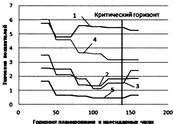
Рис. 8.18 Параметры расписаний для разных горизонтов: 1 – приведенные затраты переналадок за один рабочий день; 2 – полезность выполняемого набора работ; 3 – коэффициент неравномерности загрузки; 4 – коэффициент группирования; 5 – коэффициент запаздывания, умноженный на 5
