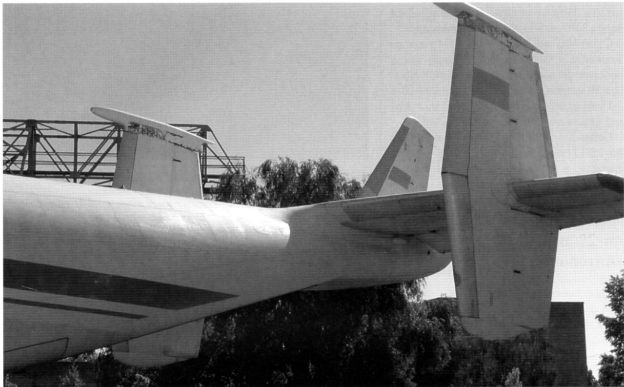
Дополнительный киль от самолета Ан-24 между шайбами вертикального оперения Ан-22ПЗ UR – 64459
