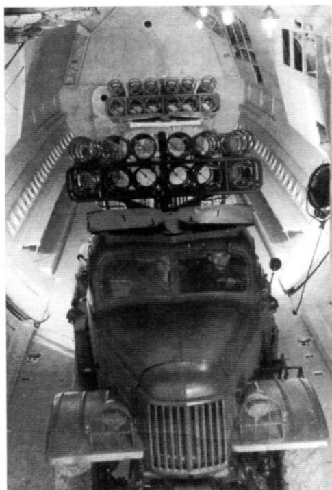
Размещение боевых машин реактивной системы залпового огня на шасси ЗИЛ-157 в макете Ан-22
