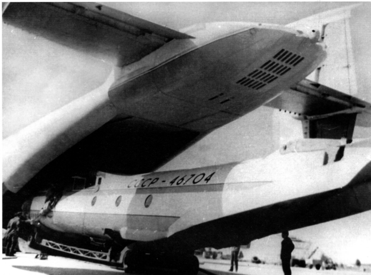
Загрузка фюзеляжа грузового самолета Ан-26 в «Антей»
