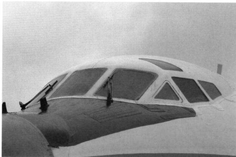
Остекление фонаря кабины пилотов
