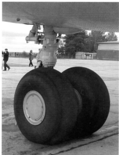
Передняя опора шасси
