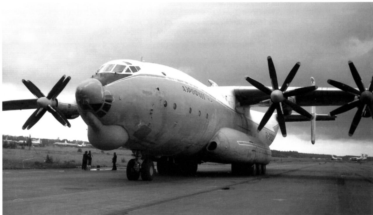
Ан-22 № 03-09 (RA – 09322) на аэродроме Чкаловская. В полете 7 апреля 1988 года на высоте 3000 метров (командир майор Ю.А. Антипов) разрушился внутренний пневматик колеса средней стойки левой основной опоры шасси. Осмотрев поврежденное колесо, командир корабля прекратил выполнение задание и произвел посадку на своем аэродроме. Причиной разрушения стал глубокий порез шины во время руления, что проявилось на высоте из-за возросшей разности давления
