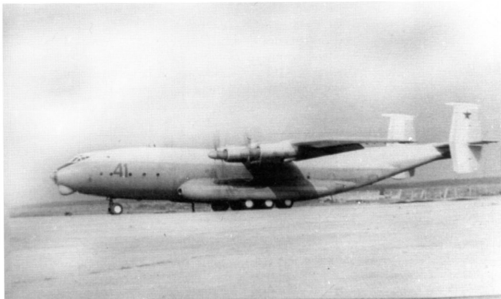
Ан-22 с бортовым номером № 41, но с антенной РЛС, установленной под кабиной штурмана
