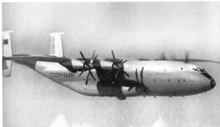
Испытания подтвердили возможность полета с двумя остановленными двигателями на одном полукрыле
