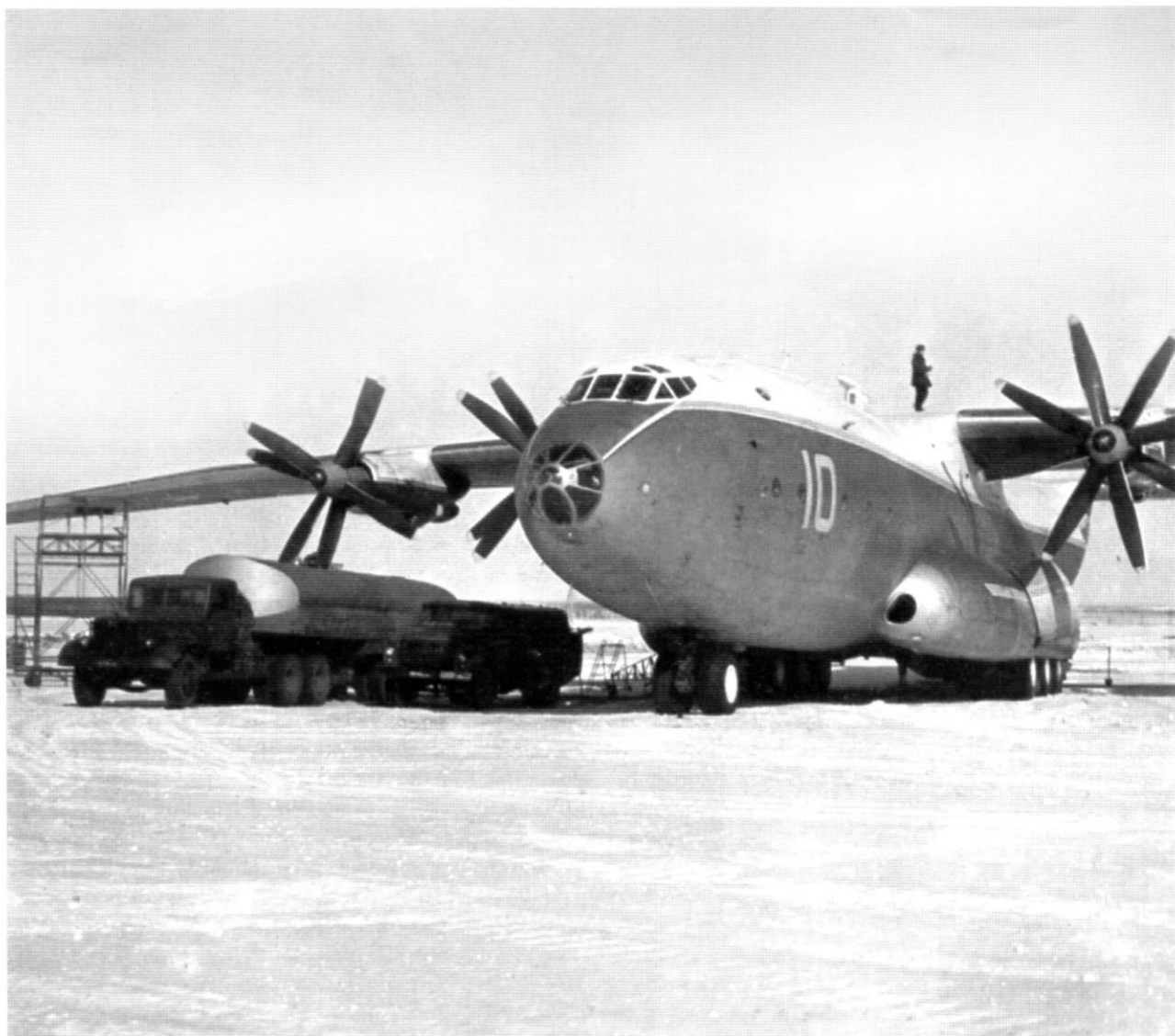
Подготовка к загрузке самоходной ракетной установки в Ан-22 № 01-10 (РА – 09310) 81-го втап. Самолет активно эксплуатировался до осени 1979 года, когда с него сняли отъемную среднюю часть крыла, а также свыше 100 агрегатов для восстановления Ан-22 № 01-09. После чего он простоял в неисправном состоянии около трех лет и был восстановлен на авиаремонтном заводе в Иванове после изготовления новых агрегатов несущей поверхности на ТАПОиЧ. Списан в октябре 1995 года по истечении календарного срока службы. За 26 лет Ан-22 налетал 3278 часов и выполнил 1842 посадки.
