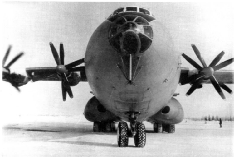
Ан-22 № 01-03 на испытаниях. Обратите внимание на штангу приемника воздушного давления в носовой части фюзеляжа и протектор колес раннего образца
