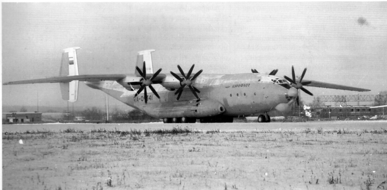
Самолет № 06-04 (РА – 09341) с автоматами постановки пассивных помех АПП-50 на обтекателях отсеков уборки шасси. Фото М. Никольского
