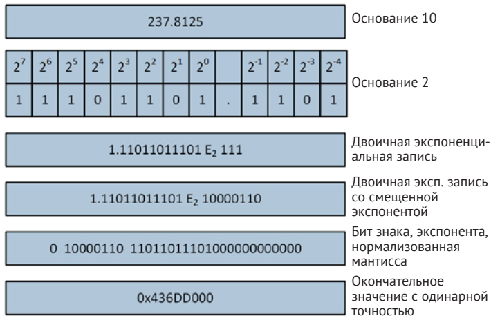
Рис. 4.9. Процесс кодирования числа с плавающей запятой одинарной точности
