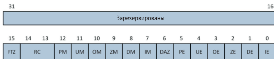
Рис. 4.11. Регистр управления и состояния MXCSR
